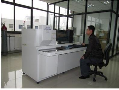
XRF-1800 型 X 射线荧光光谱仪
